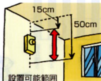
壁に取り付ける場合、天井から 15cm ~ 50cm の間に警報器の中心がくるように設置しましょう。
