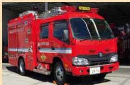
この車両は、初期消火の効率を高めるため、800リットルの水を積載し、多くの資器材が搭載できるオールシャッター構造です。
