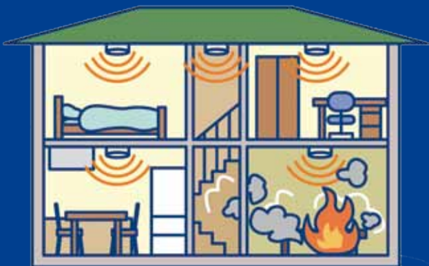
連動型住宅用火災警報器の作動イメージ
