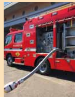
電動吸管巻取り装置
