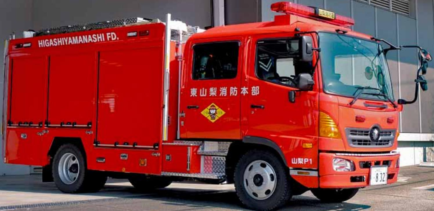
この車両は、初期消火の効率を高めるため2,000ℓの水を積載し、多くの資器材を搭載できるようオールシャッター構造で、隊員の消火活動時の負担を軽減するため電動吸管巻取り装置・電動ホースカーなどを装備した消防ポンプ自動車です。
